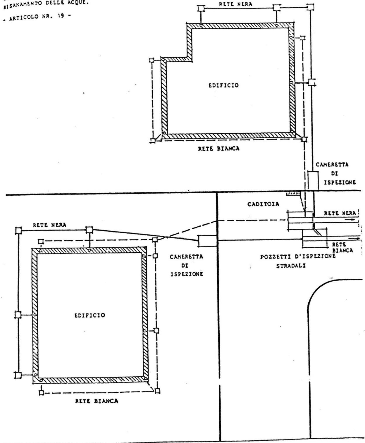
ALLEGATO "F" - SCHEMA DI ALLACCIAMENTO DELLE CANALIZZAZIONI PER ACQUE NERE ALLA FOGNATURA PUBBLICA A SEGUITO DELL'ENTRATA IN VIGORE DELLE NORME DI ATTUAZIONE DEL PIANO PROVINCIALE DI RISANAMENTO DELLE ACQUE.
